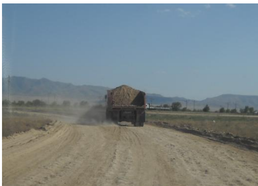
Фотография №2: Отсутствие пола у грузового автомобиля
